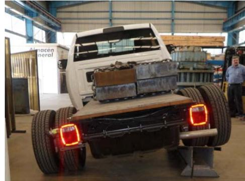
**Figura 8. Prueba de torsión, carga máxima. Vista posterior.**
