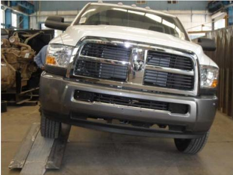
**Figura 7. Prueba de torsión, carga máxima. Vista frontal.**
